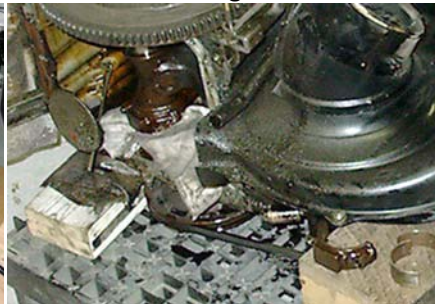
Plejlstangslejer demonteret, der var ikke meget hvidtmetal tilbage
