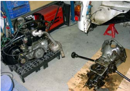
Motor og gearkasse demonteret
